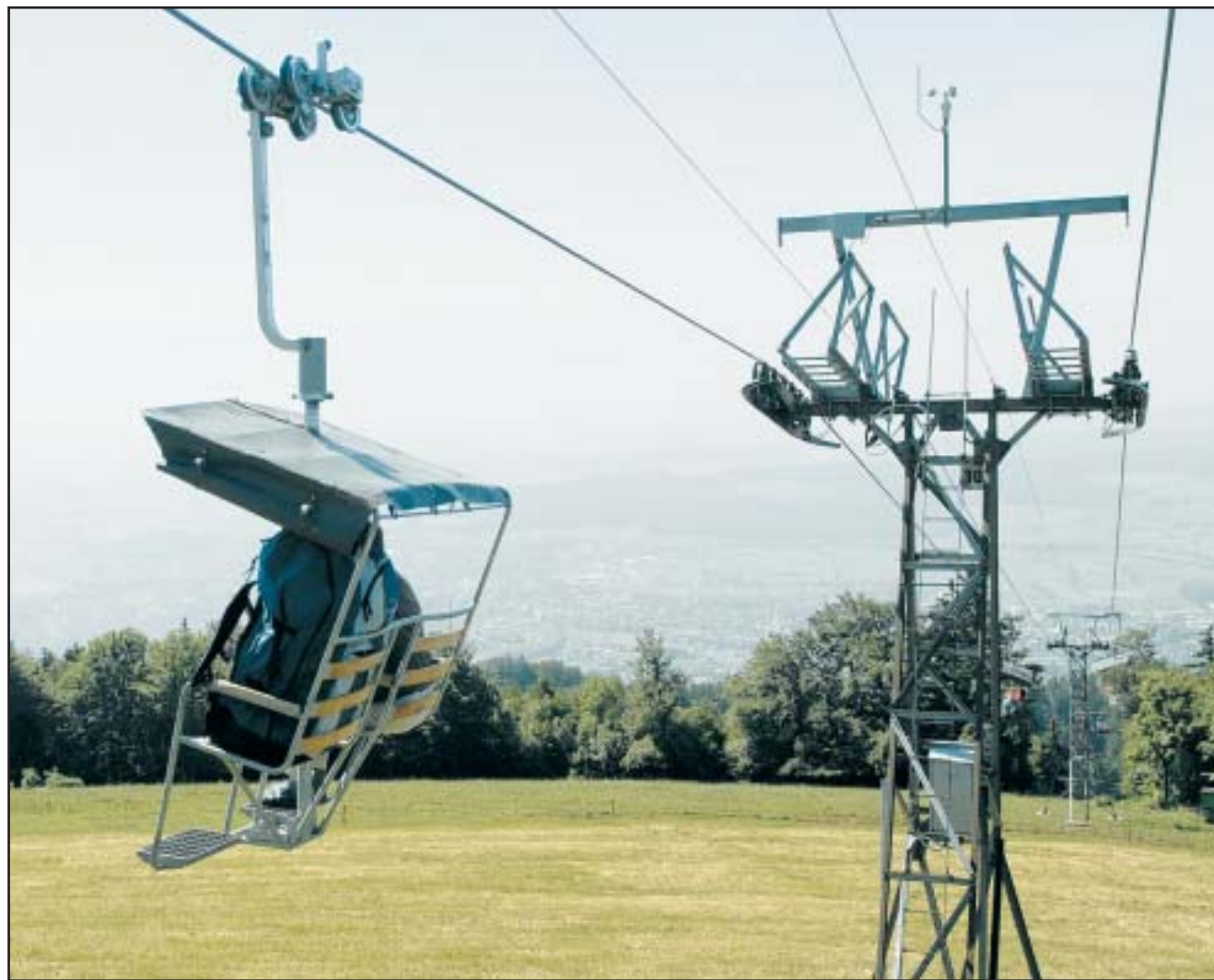
Le télésiège de Weissenstein à Soleure est le dernier avec des sièges perpendiculaires à la marche. M. ARNOLD/PATRIMOINE SUISSE
